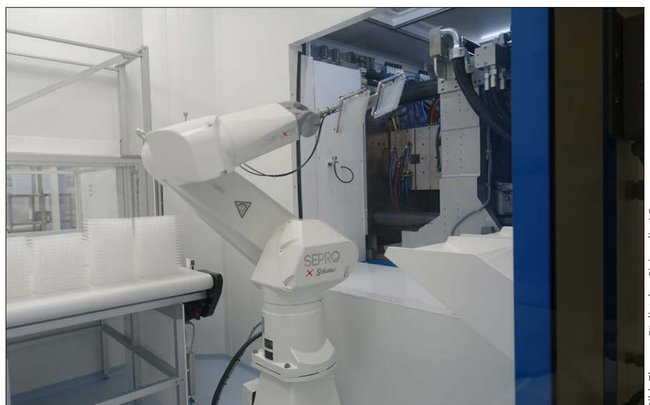
Der von Sepro installierte Knickarm-Reinraumroboter entnimmt aus der Spritzgiessmaschine das «Nest», in das beim Kunden Spritzen oder Vials gesetzt werden. Die Nester werden für die Verpackung gestapelt (links) oder für die Kontrolle ausgegeben (Schacht am rechten Bildrand)
