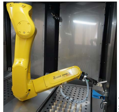
In der Zelle arbeitet ein sechssachsiger Fanuc LR Mate 200iD/7L in einer Langarmversion mit 911 mm Reichweite.
