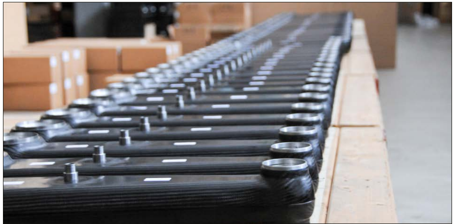
In Serie gefertigte Roboterarme aus CFK.
