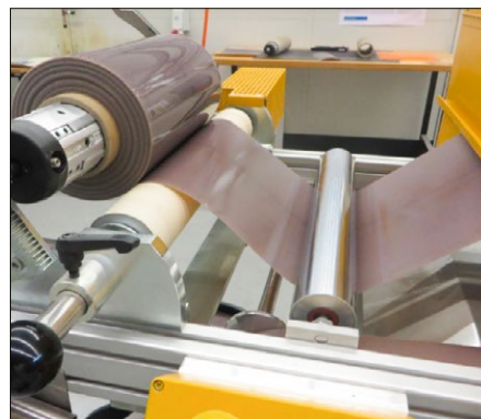
Extrusion von Folienmustern auf der 3-Schicht-Flachfolienanlage am IWK.
