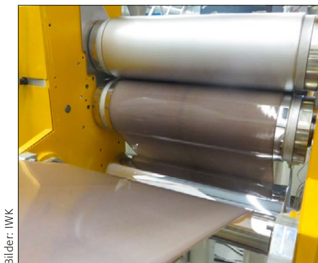
Extrusion von Folienmustern auf der 3-Schicht-Flachfolienanlage am IWK.
