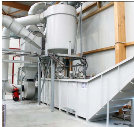
An den Extrudern entweichen neben Stäuben auch klebrige Dämpfe. Diese Luftreinigungsaufgabe löst der Nassabscheider VDN-TA, der für gute Luft an den Extrudern und in der Halle sorgt.
