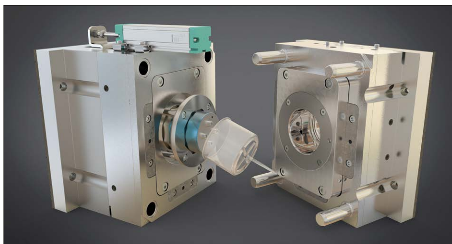
Bild 1: Spritzgiesswerkzeug mit integrierter Entformungskraft- und Wegmessung.
