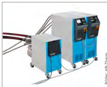
Zum variothermen Temperieren von Werkzeugen kommen bei HB-Therm zwei Temperiergeräte Thermo-5 zum Einsatz, die über die Umschalt Einheit Vario-5 mit Maschine und Werkzeug verbunden sind.
