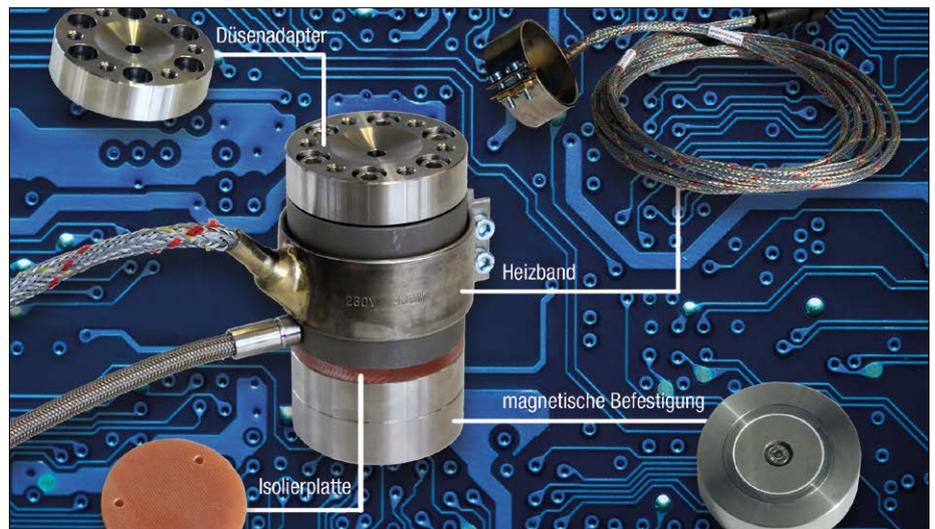
Das innovative Plug&Play-System zur Messung des Einspritzdrucks besteht aus einem Sensor mit Heizband, magnetischer Befestigung (unten) und Düsenadapter (oben).
