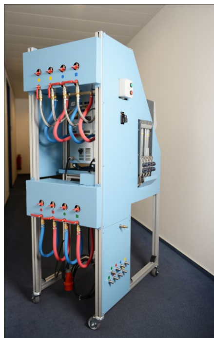
«tempy»-Dockingstation für automatisiertes Spülen von Temperierkreisläufen.
