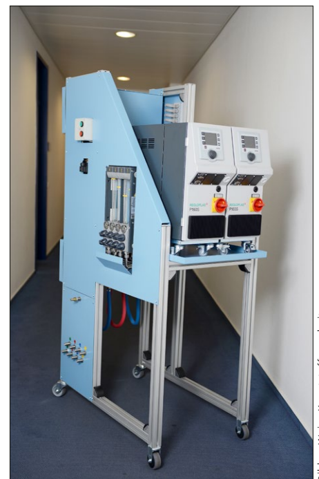
«tempy»-Dockingstation für automatisiertes Spülen von Temperierkreisläufen.
