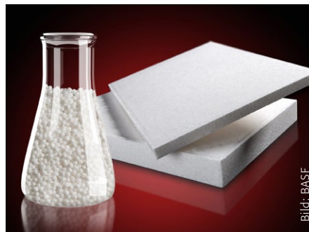
Der Partikelschaum auf Basis von PESU ist leicht, steif und fest.
