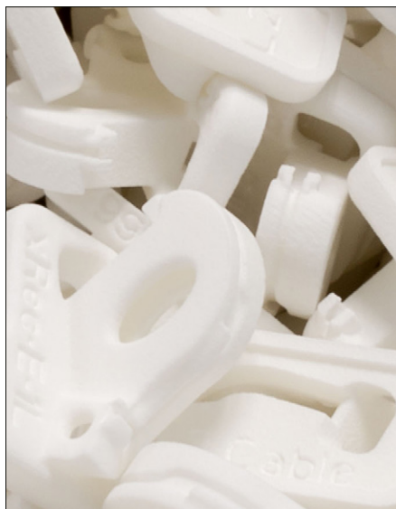
Aus cremefarben wird bunt: Eine neue Färbearlage ermöglicht das Einfärben von Lasersinterteilen in Wunschfarben.
