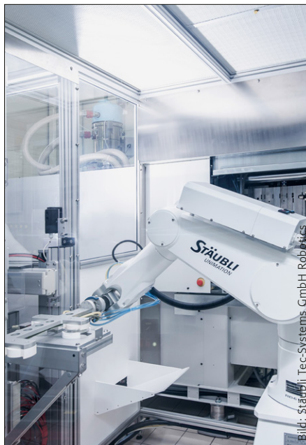
Die Stäubli-Roboter erfüllen bereits in Standardausführung die bei Plastibell geltenden Reinraumanforderungen.
