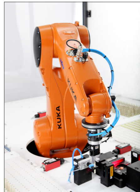
Da ein duroplastischer Kunststoff nicht verschweisst werden kann, übernimmt ein Kleinroboter von Kuka das Fügen der Bauteile mittels eines speziellen Klebers.
