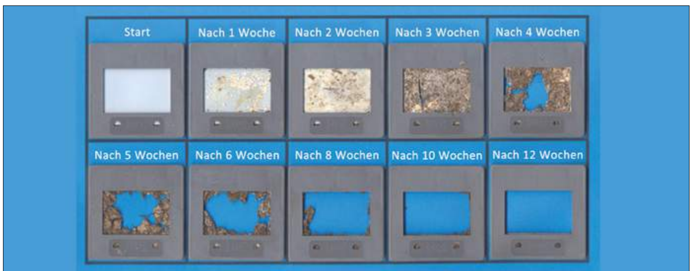
Die von AF-Color verwendete Trägermatrix wird innerhalb von 12 Wochen vollständig abgebaut; die Abbildung zeigt dies anhand einer aus mvera B5010 hergestellten 100 µm Folie. Einwegtragetaschen haben üblicherweise eine Dicke von ca. 50 µm.
