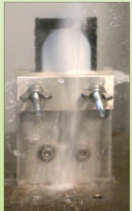
Test avec jet à haute pression répondant à la norme IP69K.
