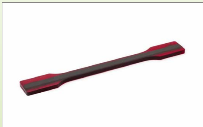
Eprouvette de traction avec bandelette intégrée.
