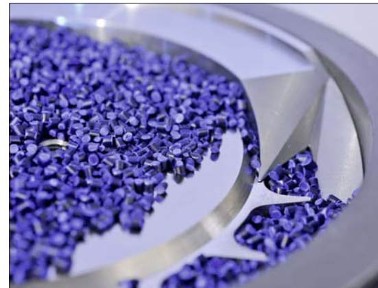
Scheibendosierorgan mit integriertem Messer als Abstreifer.
