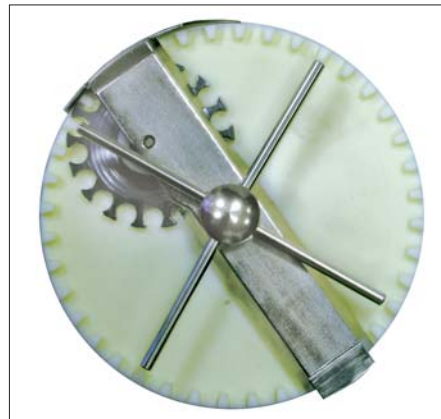
Pulverdosierstation mit Scheibendosierorgan mit Zuführhilfe und Ausdruckscheibe.
